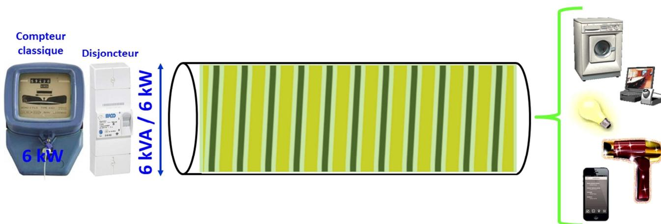
**kVA = kW → Le disjoncteur supporte jusqu'à 6 kW (30 A)**
