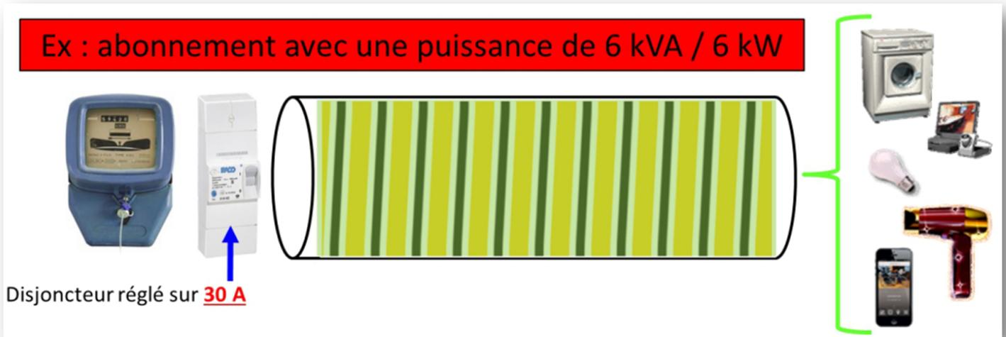
Le même logement, désormais équipé d'un compteur/capteur Linky, ne réagira plus de la même façon. En effet, c'est désormais le compteur Linky qui va se charger de mesurer la valeur de l'abonnement mais il n'est plus calibré sur l'intensité (en Ampères), mais sur la puissance apparente (en kVA ou VA).
